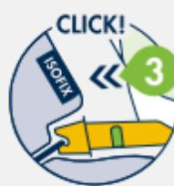
**3** Posizionare il seggiolino sul sedile del veicolo e inserire entrambi i connettori nei punti di ancoraggio ISOFIX fino a quando non si sente un "click".
