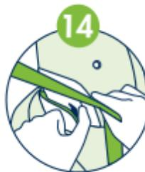
**14** Presione el seguro de la guía del cinturón del hombro hacia dentro y deslice el cinturón de tres puntos fuera de la guía.
