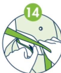
**14** Tryck in låsmekanismen till axelbältesstyrningen och skjut trepunktsbältet ut ur bältesstyrningen.
