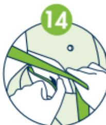
**14** Drücken Sie den Verriegelungsmechanismus der Schultergurtführung (**C**) nach innen und schieben Sie den Dreipunktgurt aus der Gurtführung.
