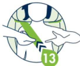
13 Ta ta i diagonalbeltet og trekk mot tilbaketrekkingsmekanismen for å fjerne slakk fra hoftebeltet.
