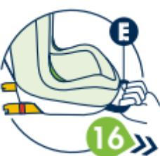
**16** Työnnä ISOFIX-liittimet turvaistuimen sisään samalla kun vedät istuimen etupuolella olevasta vetimestä (**E**) ja poista turvaistuin ajoneuvosta.
