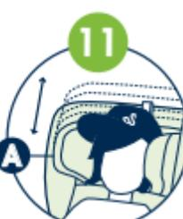
**11** 移动头枕 (A) 然后向上或向下滑动，调整头枕，直到头枕高度指示标与孩子眼部水平高度基本齐平。将安全带放进头托上的安全带导向件中，确保安全带经过孩子肩部，安全带高度离孩子肩部大约两指 (约2 cm)
