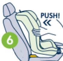
**6** ...spingere la seduta del seggiolino contro il sedile del veicolo finché non vi è saldamente ancorato. Se il poggiatesta del sedile del veicolo interferisce con il seggiolino del bambino, regolare il poggiatesta o rimuoverlo completamente (non rimuovere il poggiatesta nei sedili del veicolo rivolti all'indietro). L'intera superficie posteriore del seggiolino Charlie deve essere in contatto con lo schienale del sedile dell'auto.
