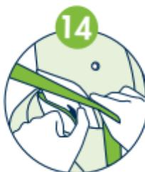
**14** Spingere il meccanismo di bloccaggio della guida della cintura trasversale (**C**) verso l'interno e far scorrere la cintura a tre punti fuori dalla guida della cintura.
