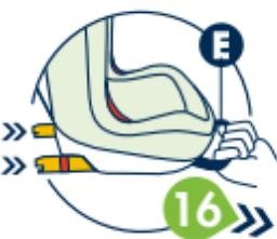
**16** 将两侧ISOFIX连接器推回座椅，同时拉上前面的皮带 (E)，然后将座椅从车辆上取下。
