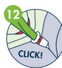
**12** 拉出三点式安全带后将其放在儿童前面，并将安全带锁舌插入汽车安全带锁扣锁紧。
