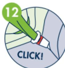
12 Trek de driepuntsgordel uit, plaats deze voor het kind en vergrendel de tong van de gordel in de gesp van het voertuig.
