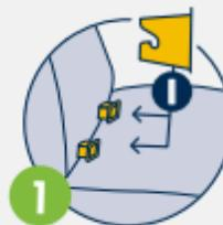
**1** Se necessario, posizionare le due guide ISOFIX (**I**) su entrambi i punti di ancoraggio ISOFIX tra la seduta e lo schienale del sedile del veicolo.
