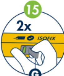
**15** Öffnen Sie die ISOFIX-Konnektoren, indem Sie an dem ISOFIX-Entriegelungshebel (**G**) direkt an der Seite der Konnektoren ziehen.
