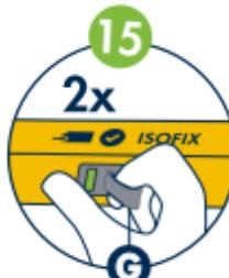
**15** Abra los conectores ISOFIX (**F**) tirando de la pieza de liberación ISOFIX (**G**) que se encuentra junto a los conectores. En caso de que la correa de liberación ISOFIX (**E**) no sea accesible, use el tirador delantero (**E**) para desplazar el asiento hacia delante.
