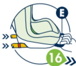
**16** Schieben Sie die ISOFIX-Konnektoren zurück in den Sitz, während Sie am Band an der Vorderseite ziehen (**E**). Nehmen Sie den Sitz dann aus dem Fahrzeug.
