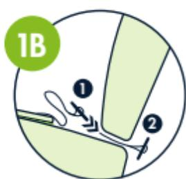
**1B** Wenn der Sitz nicht mit ISOFIX-Konnektoren ausgestattet ist, öffne die Gurtbänder, entferne die Haken und ersetze sie durch die Verankerungsplatten, die sich im beiliegenden Umschlag befinden. Schiebe sie bis zum Anschlag zwischen der Rückenlehne und dem Sitzkissen des Sitzes durch. Sehr gut!
