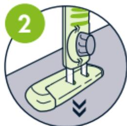
**2** Ruotare la bella manopola grigia in senso antiorario. Estrarre il piede della gamba fino a raggiungere il pavimento del veicolo. Una volta definita l'altezza, fissare la posizione stringendo la manopola in senso orario. A proposito di orologi... che ore sono? Sì, è l'ora della felicità!
