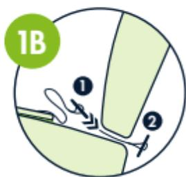
**1B** Se il sedile non è dotato di connettori ISOFIX: Aprire le fettucce, rimuovere i ganci e sostituirli con le piastre di ancoraggio contenute nella busta in dotazione. Farle scorrere fino in fondo tra lo schienale e il cuscino del sedile. Liscio!
