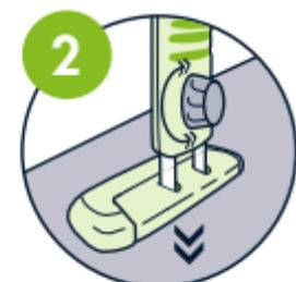
**2** Tournez la belle molette grise dans le sens inverse des aiguilles d'une montre. Tirez le pied de la jambe jusqu'à ce qu'il atteigne le plancher du véhicule. Une fois la hauteur définie, sécurisez la position en serrant le bouton dans le sens des aiguilles d'une montre. En parlant d'horloge... quelle heure est-il ? Oui, c'est l'heure du bonheur !
