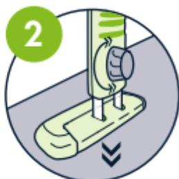
**2** Drei den vakre grå knotten mot urviseren. Trekk ut benets fot til det når bilens gulv. Når høyden er definert, sikrer du posisjonen ved å stramme knotten med klokken. Apropos klokker... hva er klokken? Ja, klokken er happy o'clock!
