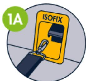
**1A** Dacă scaunul pe care instalați suportul pentru picioare este echipat cu conexiuni ISOFIX: Vă rugăm să agățați cârligele pe punctele de ancorare ISOFIX. Acum dansați dansul!
