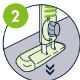
**2** 逆时针旋转脚踏支撑腿背面的浅灰色旋钮, 拉长支撑腿直到底部支撑板接触到地面。确保支撑腿高度适宜后, 请顺时针旋转浅灰色旋钮, 使支撑腿长度锁定。看下时间, 是不是很快就搞定!
