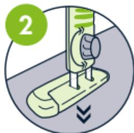
**2** Obróć piękne szare pokrętko w kierunku przeciwnym do ruchu wskazówek zegara. Wyciągnij stopę nogi, aż dotknie podłogi pojazdu. Po określeniu wysokości, zabezpiecz pozycję, dokręcając pokrętko w kierunku zgodnym z ruchem wskazówek zegara. Mówiąc o zegarach... która jest godzina? Tak, jest szczęśliwa godzina!
