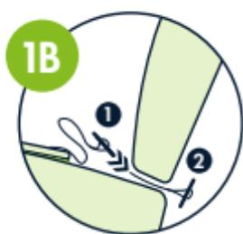
**1B** 如果要安装脚踏的座位不配备 ISOFIX 接口, 请将两个挂钩从织带上取下, 拿出包装盒中附带的带孔锚状固定板, 将固定板慢慢塞入汽车座位靠背与坐垫之间, 确保它在里面平整地卡住, 从水平方向不会被拖拽出来。顺利完成第一步!
