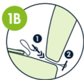
**1B** Om sätet inte är utrustat med ISOFIX-anlutningar: Öppna banden, ta bort krokarna och ersätt dem med förankringsplattorna som finns i det medföljande kuvertet. Skjut in dem hela vägen mellan ryggstödet och sittdynan på sätet.
