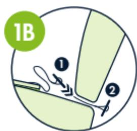
**1B** Si le siège n'est pas équipé de connecteurs ISOFIX : Ouvrez les sangles, retirez les crochets et remplacez-les par les plaques d'ancrage fournies dans l'enveloppe. Glissez-les jusqu'au bout entre le dossier et le coussin du siège. Doucement !
