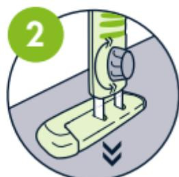
**2** Drehe den schönen grauen Drehknopf gegen den Uhrzeigersinn. Ziehe den „Fuß“ der Fußstütze heraus, bis er den Boden des Fahrzeugs erreicht. Sobald die Höhe definiert ist, sicherst du die Position, indem du den Drehknopf im Uhrzeigersinn festdrehst. Apropos Uhr... wie spät ist es? Es ist Zeit für ein fröhliches Lächeln!
