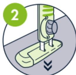
**2** Zakrenite prekrasan sivi gumb u smjeru suprotnom od kazaljke na satu. Izvucite stopalo noge dok ne dosegne pod vozila. Nakon što je visina definirana, osigurajte položaj zatezanjem gumba u smjeru kazaljke na satu. Kad smo već kod satova... koliko je sati? Da, sretan je sat!
