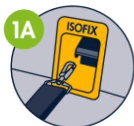
**1A** Si le siège sur lequel vous installez le repose-pieds est équipé de connexions ISOFIX : Accrochez les crochets aux points d'ancrage ISOFIX. Maintenant, dansez la danse !
