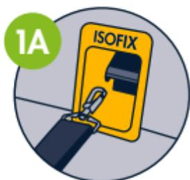
**1A** Якщо сидіння, на яке ви встановлюєте підніжку, обладнане кріпленнями ISOFIX: Будь ласка, зачепіть гачки в точках кріплення ISOFIX. Тепер танцюйте танець!
