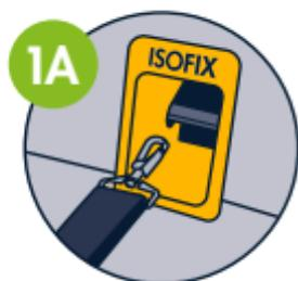
**1A** Wenn der Sitz, an dem du die Fußstütze montieren willst, mit ISOFIX-Konnektoren ausgestattet ist, hake diese bitte an den ISOFIX-Verankerungspunkten ein. Und schon kann es weiter gehen!
