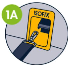
**1A** 如果要安装脚踏的座位配备 ISOFIX 接口, 请将挂钩挂在 ISOFIX 接口内部的金属杆上, 现在第一步搞定!
