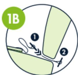
**1B** Če sedež ni opremljen s priključki ISOFIX: Odprite trakove, odstranite kljuke in jih zamenjajte s sidrnimi ploščami, ki jih najdete v priloženi ovojnici. Potisnite jih do konca med naslonjalo in sedežno blazino sedeža. Gladko!
