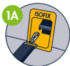
**1A** Om sätet där du installerar fotstödet är utrustat med ISOFIX-anslutningar: Vänligen haka fast krokarna på ISO-FIX-förankringspunkterna. Dansa nu dansen!
