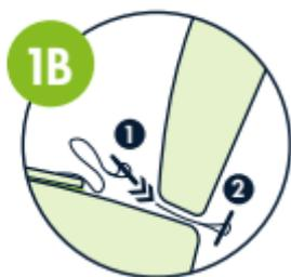
**1B** Если сиденье не оборудовано разъемами ISOFIX: Пожалуйста, расстегните ремни, снимите крючки и замените их анкерными пластинами, которые находятся в прилагаемом конверте. Вставьте их до упора между спинкой и подушкой сиденья. Гладко!
